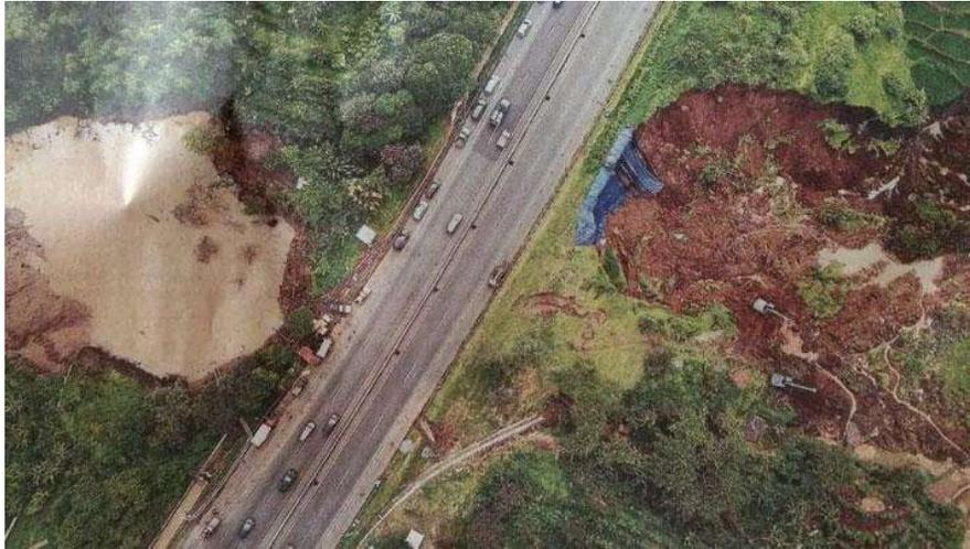
Gambar 4 Kondisi longsor pada tanah Clayshale di Tol Cipularang (Irsyam et al, 2010)
