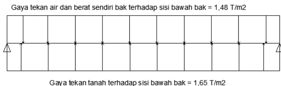
Gambar 5. Pembebanan pada dasar bak (terisi penuh)
