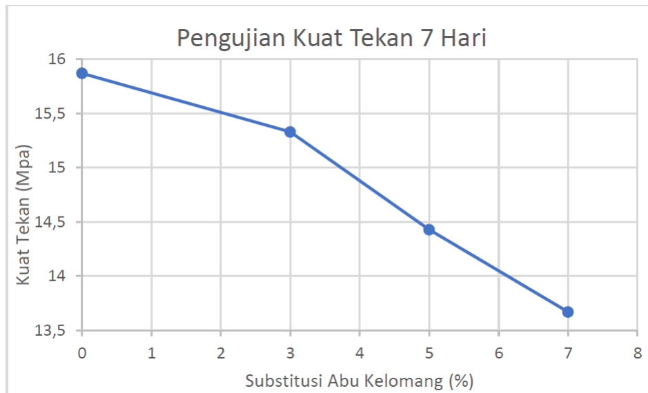
Gambar 5. Grafik pengujian kuat tekan beton 7 hari
