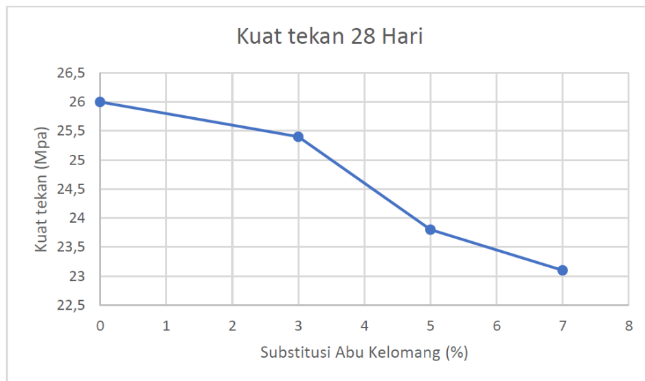
Gambar 6. Grafik pengujian kuat tekan beton 28 hari
