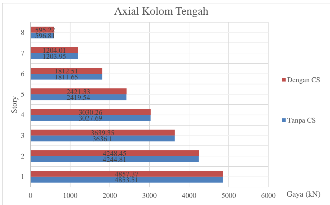
Gambar 5. Grafik perbandingan gaya axial kolom tengah.
