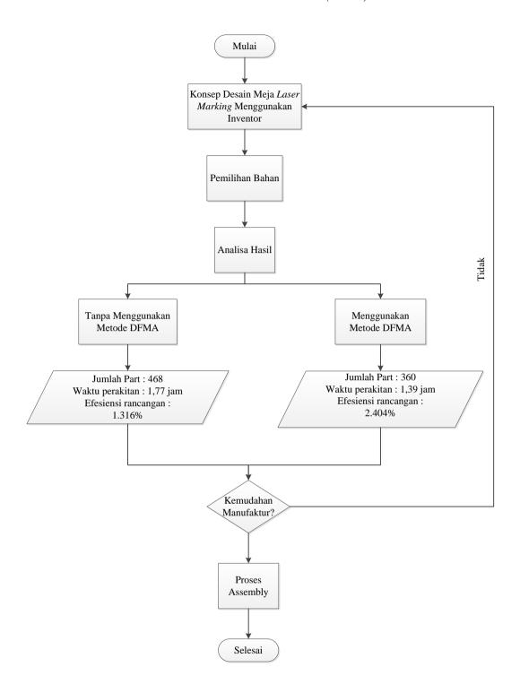
Gambar 1. Diagram Alir Proses Pembuat Meja Laser Marking
