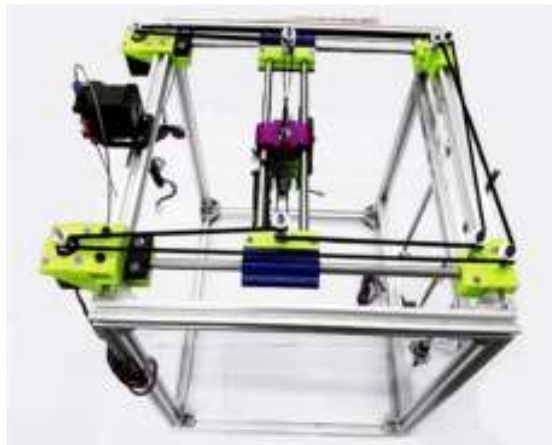
Gambar 9. Prototipe fisik printer 3D dengan parallel XY.
