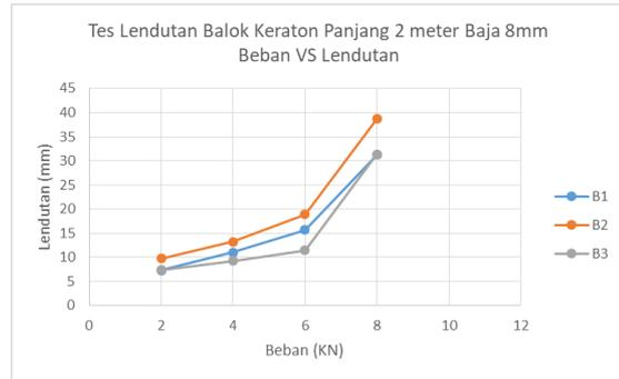
Gambar 7. Grafik Beban Vs Lendutan Balok Keraton Bentang 2 meter Baja Tulangan 8 mm
