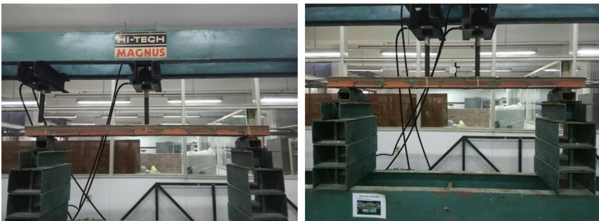
Gambar 6. Pengujian Balok Keraton Satu Beban dan Dua Beban
