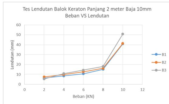
Gambar 8. Grafik Beban Vs Lendutan Balok Keraton Bentang 2 meter Baja Tulangan 10 mm
