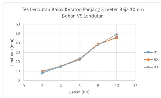
Gambar 10. Grafik Beban Vs Lendutan Balok Keraton Bentang 3 meter Baja Tulangan 10 mm
