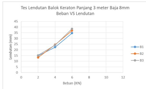
Gambar 9. Grafik Beban Vs Lendutan Balok Keraton Bentang 3 meter Baja Tulangan 8 mm
