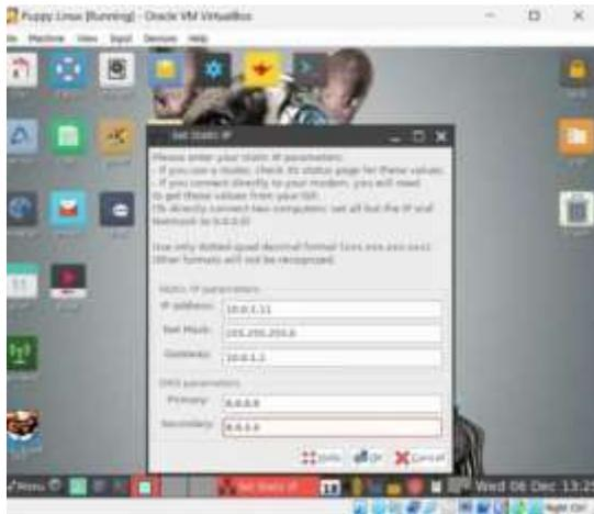
Gambar 9. Setting IP pada Web Client.
