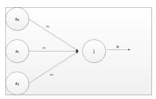
Elemen pada Gambar 1 adalah unit pengolah dasar dari *percpetron*. Unit pengolah ini mendapat masukan dari unit pengolah lain yang masing-masing dihubungkan melalui suatu bobot interkoneksi. Unit pengolah melakukan penjumlahan berbobot untuk seluruh masukannya.[4] Terdapat dimana rumus[5]:
