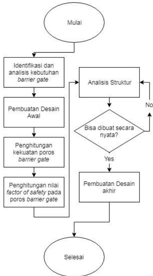
Gambar 1. Diagram Alir Perancangan *Barrier Gate*
