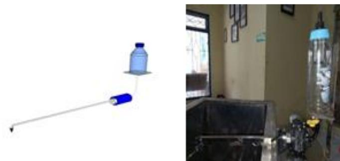
Gambar 6. Draft Sistem Injeksi dan Hasil Pembuatan Sistem Injeksi
