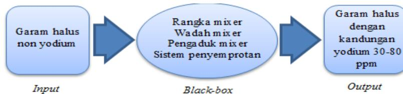
Gambar 2. Diagram Black Box Mesin
