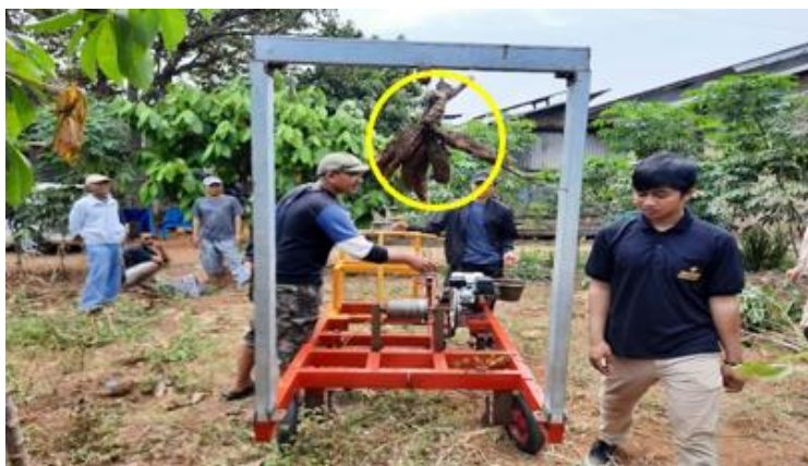
Gambar 5. Uji Coba Alat (Gambar 4) dan Berhasil Mencabut Singkong (lingkaran kuning) Sumber: Sundari et al. [10]
