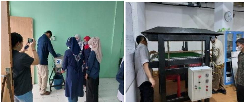
Kegiatan pelatihan dan praktek pembuatan papan lembaran dilakukan dengan menggunakan cacahan sampah plastik dari sampah botol plastik air mineral dengan klasifikasi *polyethylene therephtalathe* (PET), dan *high density polyethylene* (HDPE). Gambar 4 papan lembaran daur ulang sampah plastik yang dihasilkan dari pelaksanaan pelatihan.
