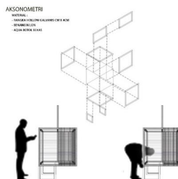
Gambar 9. Simulasi Pembuatan Rangka Modular (Sumber: Dokumentasi Pribadi, 2017)
