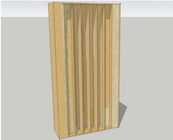
Gambar 6: Model panel diffuser berdasarkan quadratic-residue sequences dari schroeder diffuser dengan 8 alur masing-masing kedalaman 0-1-4-2-2-4-1-0
