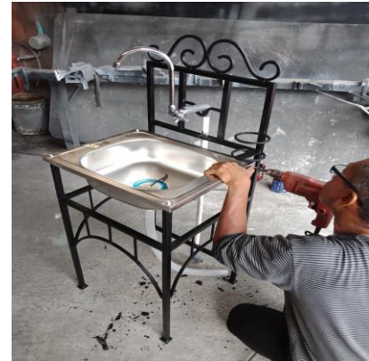
Gambar 24. Menyekrup bak Wastafel dan Memasang Pipa Keran
