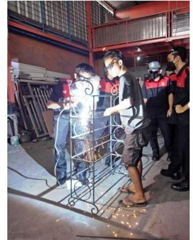
Gambar 20. Mengelas Rangka Keseluruhan
