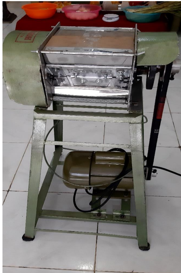
Gambar 2.2. Penyerut Rempah Sumber: Penulis, 2022
