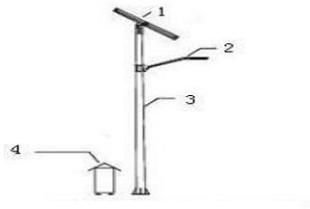
Lampu LED dengan tenaga surya yang baterai dan sensornya sudah menyatu, dipilih karena praktis dan tidak membebani masyarakat desa untuk pemeliharaannya. Modul Lampu PJU yang digunakan mempunyai spesifikasi solar panel 6 V 1,8 Watt terdiri dari 15 buah LED 0,9 W. Lampu Energi Surya yang digunakan dapat dilihat pada gambar 4.
