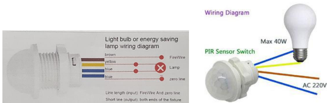
Gambar 6. Cara Koneksi Sistem Penerangan dengan Sensor PIR
