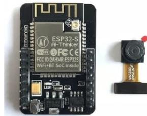
Gambar 4. ESP-32 CAM *module*
