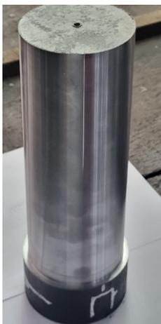
Gambar 4. Benda Kerja Baja AISI 4340
