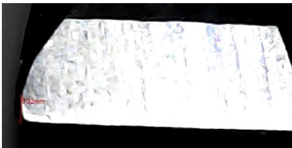
Gambar 7. Keausan Pahat pada Depth of Cut 0.5 mm pada menit ke 30
