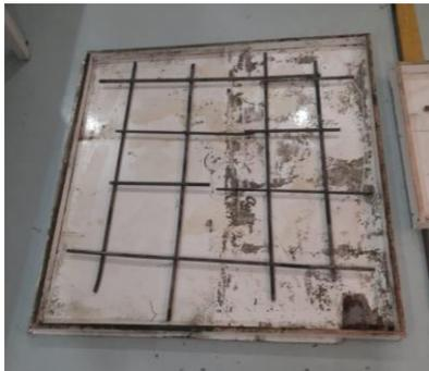
Setelah cetakan dan material siap dilanjutkan dengan proses pencampuran menggunakan mixer tangan dengan kecepatan putar 100 rpm. Pada saat adukan telah jadi, proses dilanjutkan dengan penuangan dalam cetakan. Sehari setelah pencetakan beton komposit yang telah keras dikeluarkan dari cetakan dan direndam dalam air selama 28 hari. Beton komposit dirapikan pada bagian ujungnya sebelum dipasang di lapangan. Proses penuangan beton dalam cetakan ditunjukkan dalam gambar 4.
