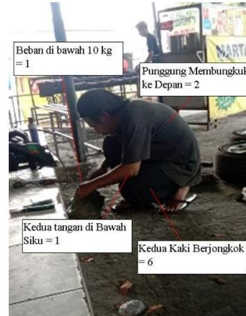
Gambar 7. Analisis OWAS pada Postur Kerja Berdiri Membungkuk      Gambar 8. Analisis OWAS pada Postur Kerja Berjongkok
