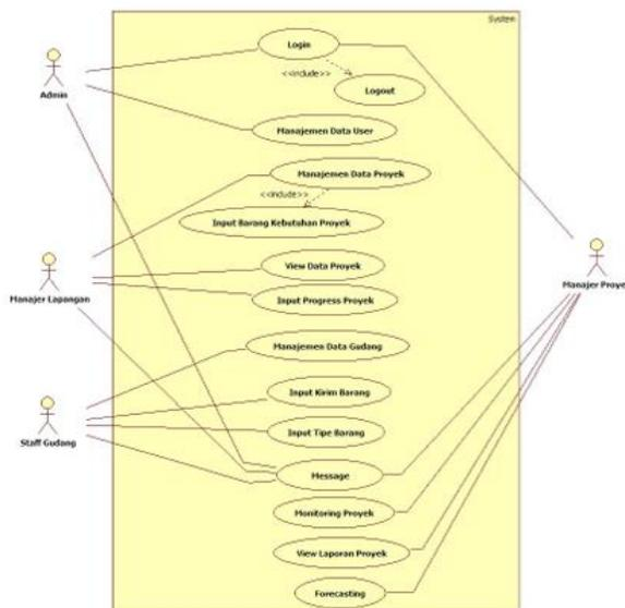
Gambar.5 Use Case Diagram Sistem Informasi Eksekutif Monitoring Proyek
