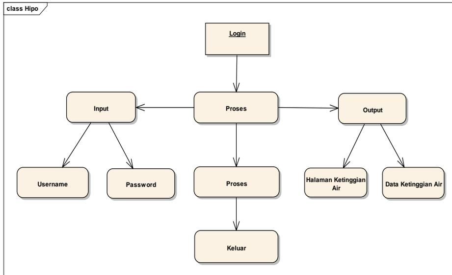
Gambar 6. Rancangan HIPO Sistem Pendeteksi Ketinggian Air
