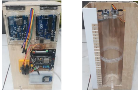
Gambar 8. Implementasi Desain Perangkat Keras Arduino Wemos D1 Dan Sensor Ultrasonik
